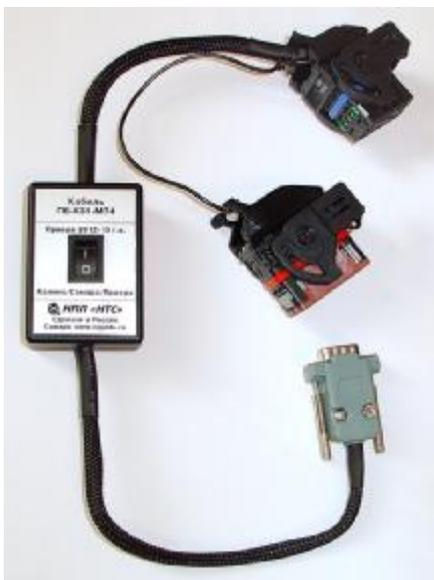
Кабель выпущен в связи с тем, что АВТОВАЗ сменил контакт разъема ЭБУ М74, используемый для подключения программатора.
